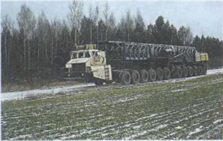
Двенадцатиосный ракетовоз МАЗ-7907 можно назвать самым внушительным тягачом Советского Союза. У него было 24 ведущих колеса, 16 из них управляемые, а в движение он приводился от танкового газотурбинного мотора мощностью 1250 л.с.
